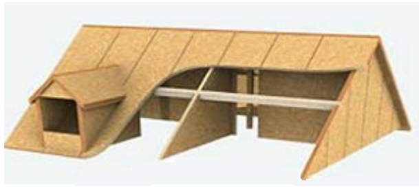
Charpente poutre lamellées collées
